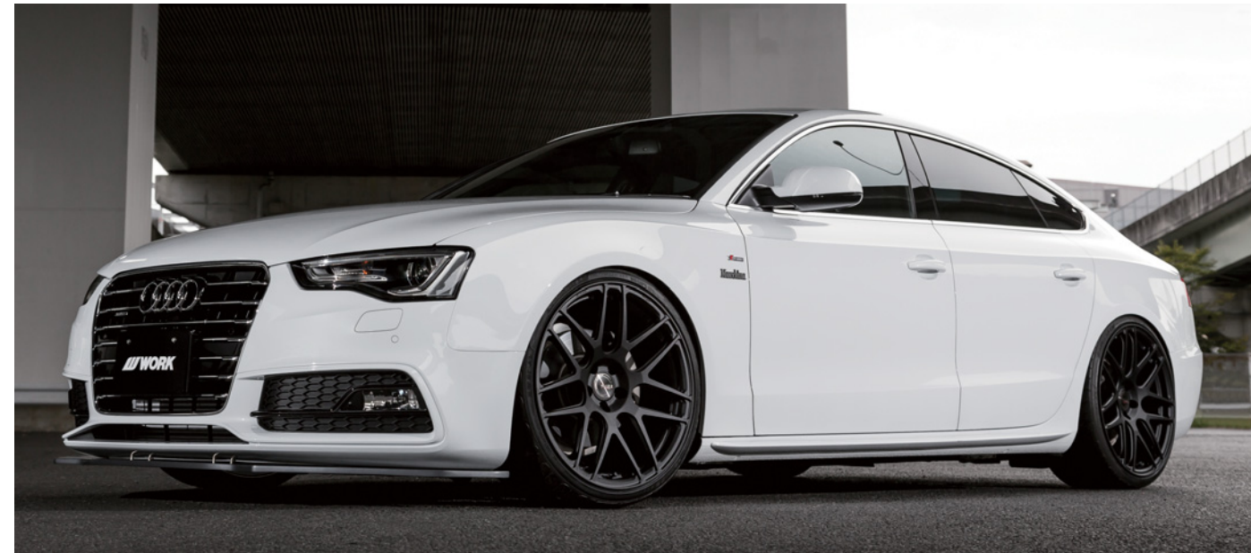
[SIZE] FRONT : 20inch × 10.0J INSET 25mm TIRE : 255/30-20 REAR : 20inch × 10.0J INSET 25mm TIRE : 255/30-20 COLOR : ブラックアノダイズド (SKA/B)
